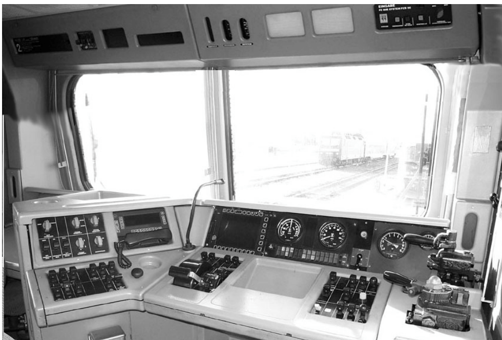
Das obere Foto zeigt das Führerpult der BR 143
