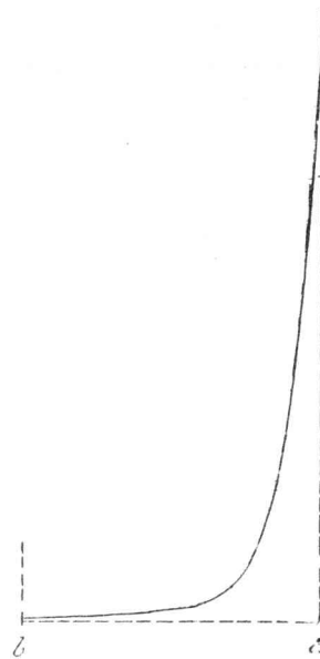
Abb. 3. Zeichnerische Darstellung der Dampfgeschwindigkeiten im Regulatorzuströmrohr.
