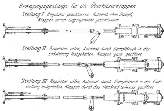
Abb. 8. Stellung der Bewegungsgestänge der Ueberhitzerklappen.
