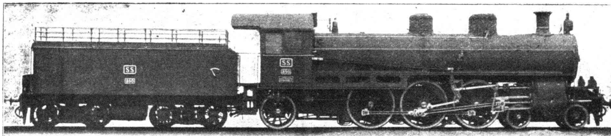
Abb. 1. 2C1-Heißdampf-Zwillings-Schnellzuglokomotive der holländischen Staatsbahnen auf Java.
