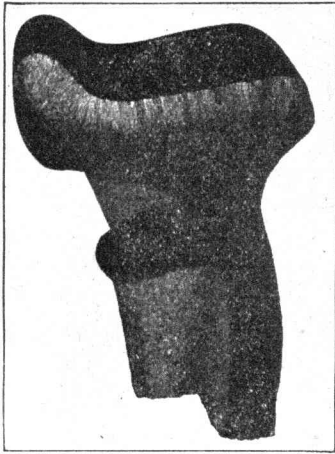
Abb. 2. Radbruchstück. Scheibe mit dem Ansatz zu Rippe und Profil; die Hartschicht ist weißes Gußeisen und verläuft strahlenförmig gegen das graue Gußeisen, wobei die Kokillenwirkung nicht ganz in die Außenseite des Spurkranzes eindringt, vielmehr dort ungehärtetes graues Gußeisen verblieben ist. Der Uebergang von der Hartschicht auf das weiche Material vollzieht sich nur allmählich, die Bruchfläche zeigt homogenes Gefüge.
