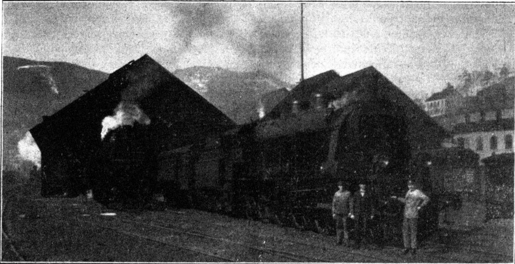
1 D1-Heißdampf-Zwillings-Schnellzuglokomotive, Reihe 670 der Österreichischen Bundesbahnen. Umbautype mit Lentz-Ventilsteuerung. (Aufnahme vor dem Heizhause Mürrzuslag mit angekuppeltem Meßwagen.)
