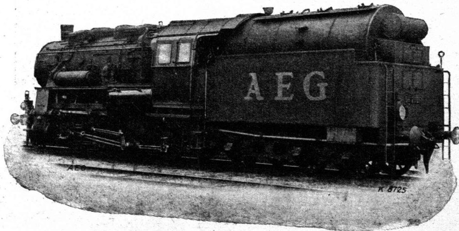
Bild 11. Seitenansicht der AEG-Kohlenstaub-Lokomotive.
