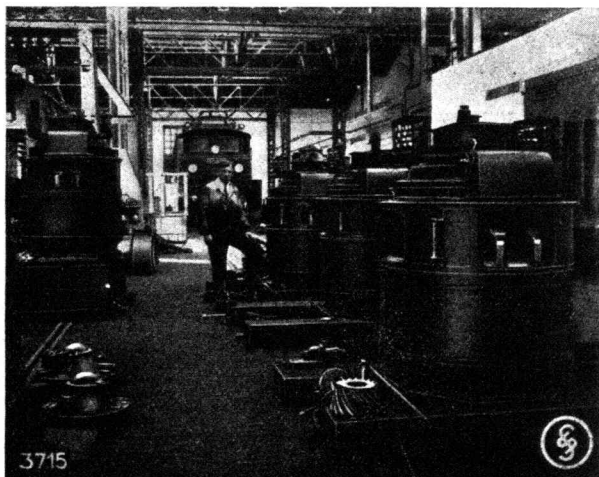
4 Vertikalmotoren für die Talschnellzugslokomotiven 1—Do—1, Reihe 1570, einbaubereit in der Montagehalle
