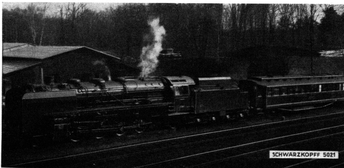
Bild 5: 1' D 1' Heißdampf-Lokomotive Nr. 41001 der Deutschen Reichsbahn mit dem Lokomotiv-Meßwagen während der Erprobung auf Bahnhof Friedrichruh
