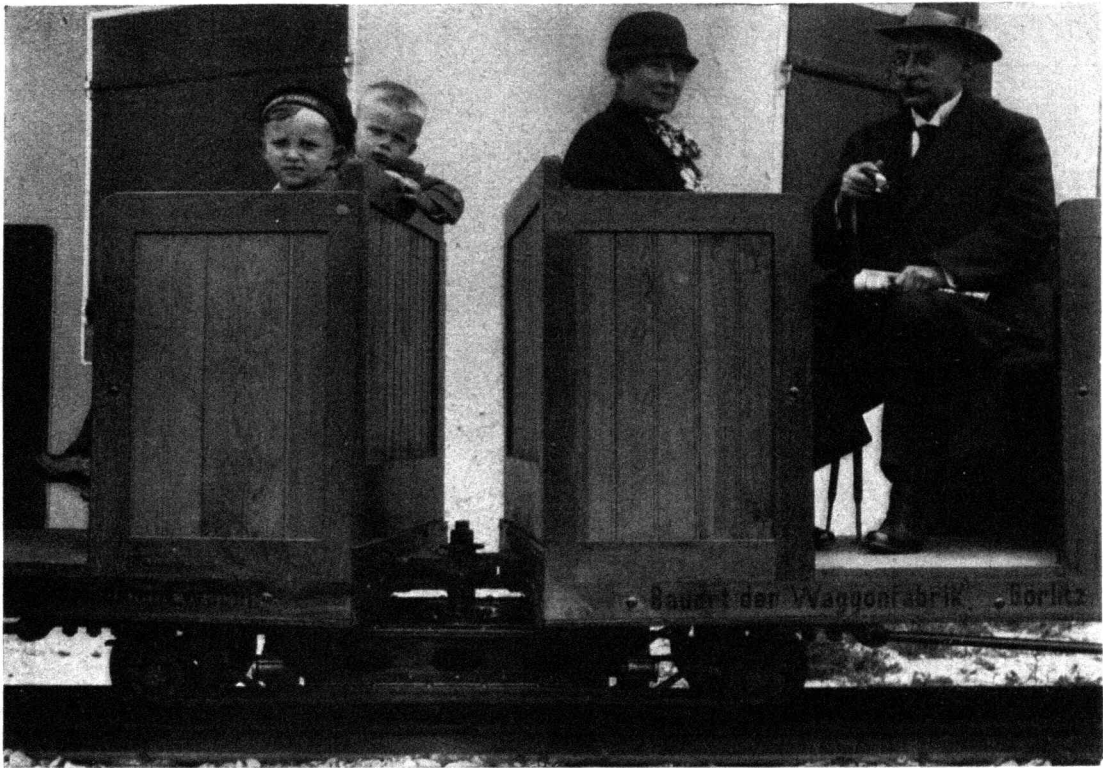
Bild 6: Jakobs-Gelenkwagen mit gemeinschaftlichem Drehgestell für je zwei Wagenkästen. Bauart der Waggon- und Maschinenbau A.-G., Görlitz.
