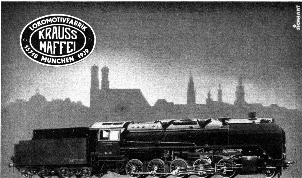
1E-H3 GÜTERZUGLOKOMOTIVE · GATTUNG G 56.20 BAUREIHE 44 FÜR DIE DEUTSCHE REICHSBAHN
