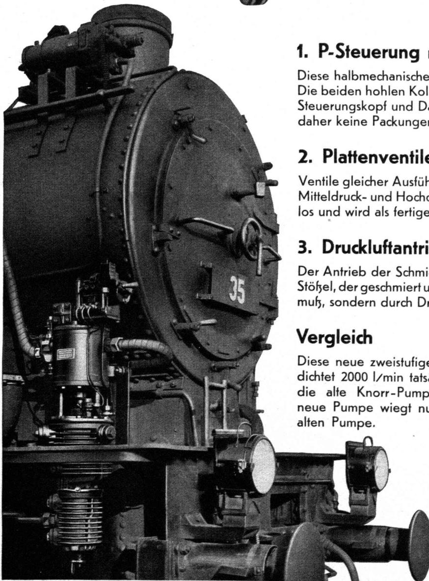
Zweistufige Luftpumpe mit P-Steuerung an einer Güterzug-Lokomotive der Mecklenburgischen Friedrich-Wilhelm-Eisenbahn-Gesellschaft - Neustrelitz
