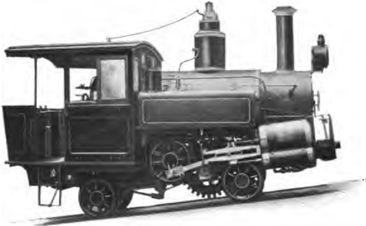
RACK LOCOMOTIVE, S. ELLERO AND VALLOMBROSA.
