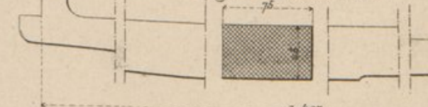
Fig. 14. — Bielle de commande du tiroir
