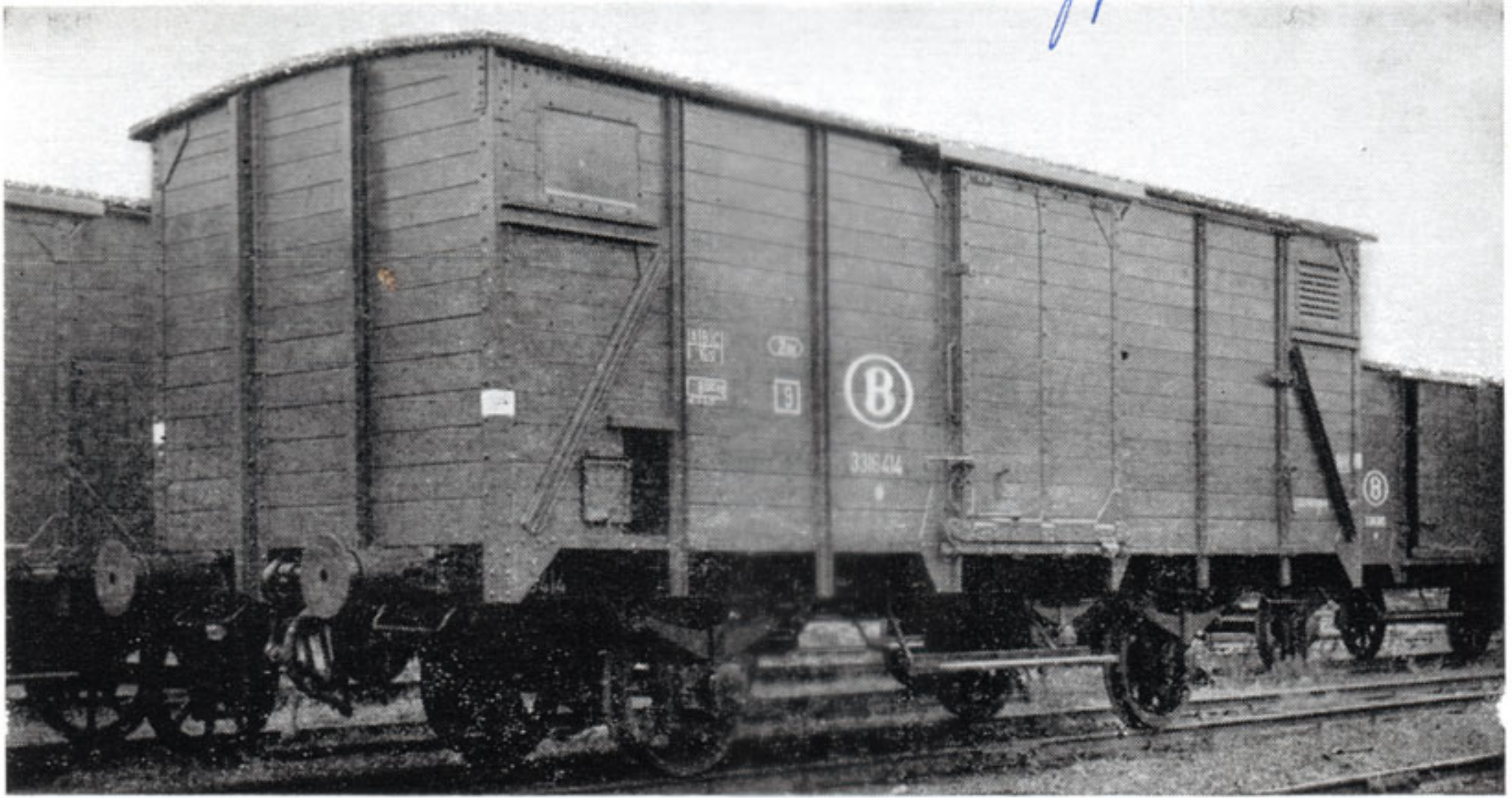
Wagon couvert (série 3.315.000-3.317.999) ; on distingue en haut à l'avant plan la trappe de chargement et, à droite, le vasistas.
