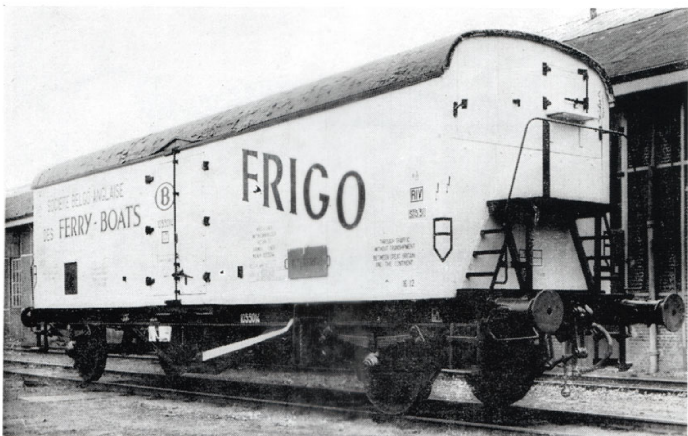
Wagon réfrigérant (série 1.055.000-1.055.059) à gabarit anglais.
