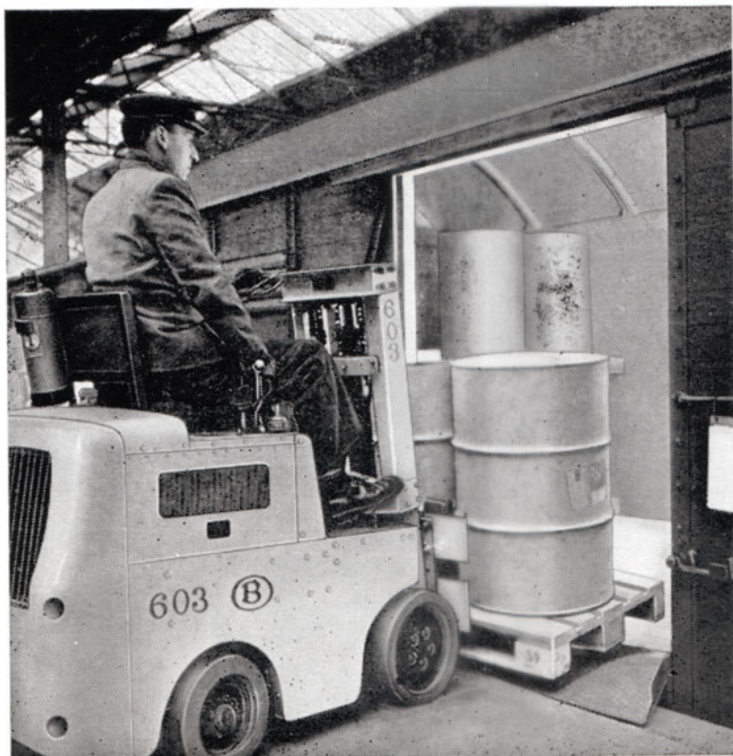
Fûts métalliques « palettisés » en cours de manipulation.
