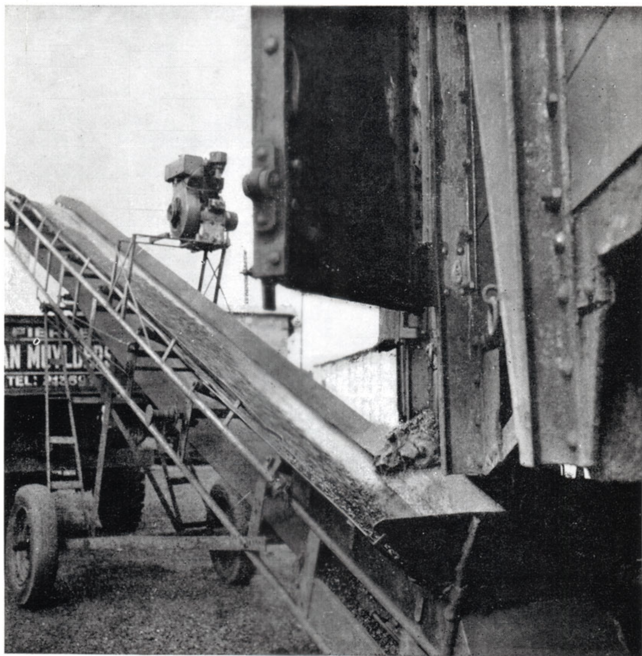
Déchargement de charbon à l'aide d'une « sauterelle », en gare de Bruxelles (Petite-Ile).
