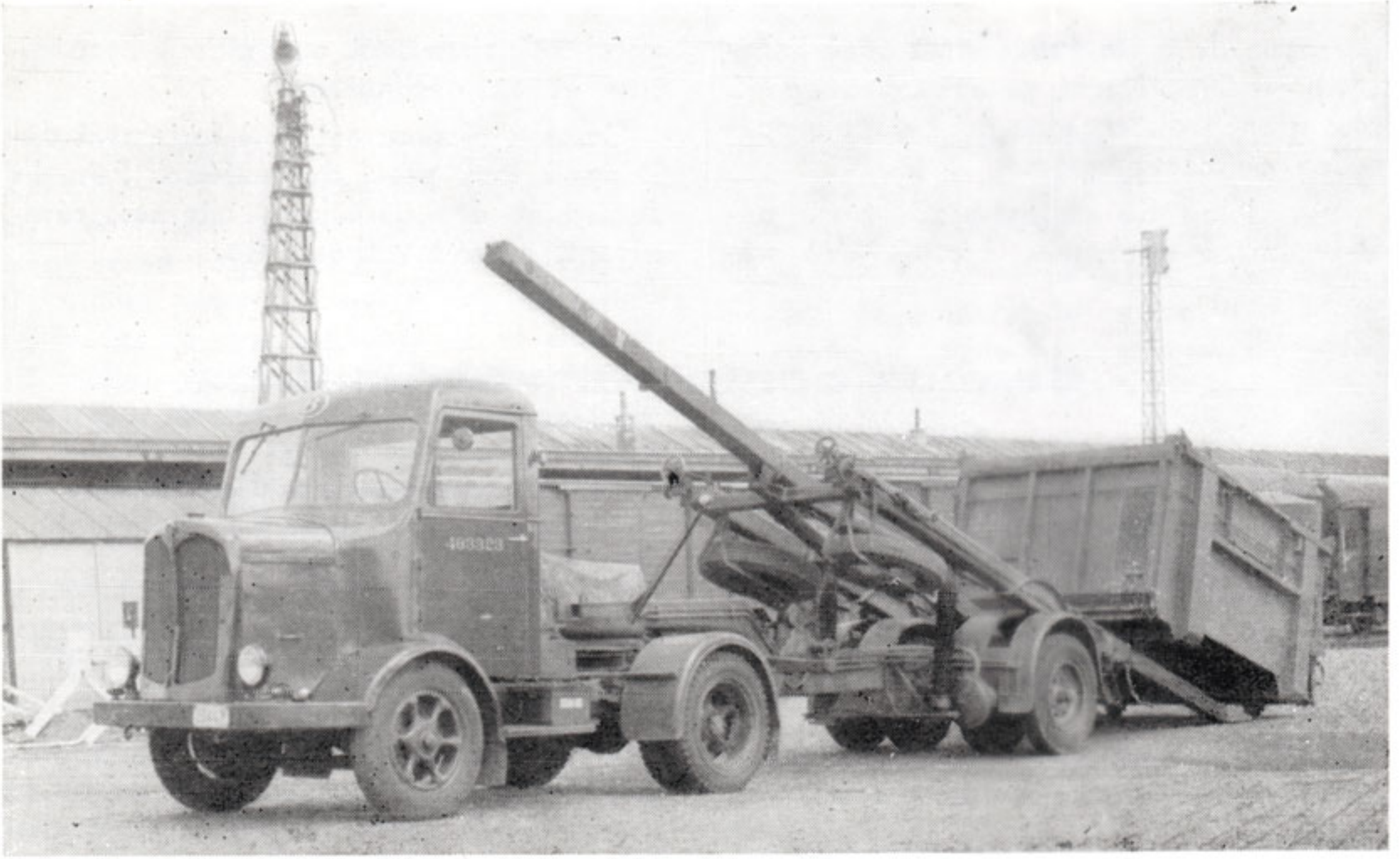
Mise au sol d'un container ouvert de 5.000 kg.
