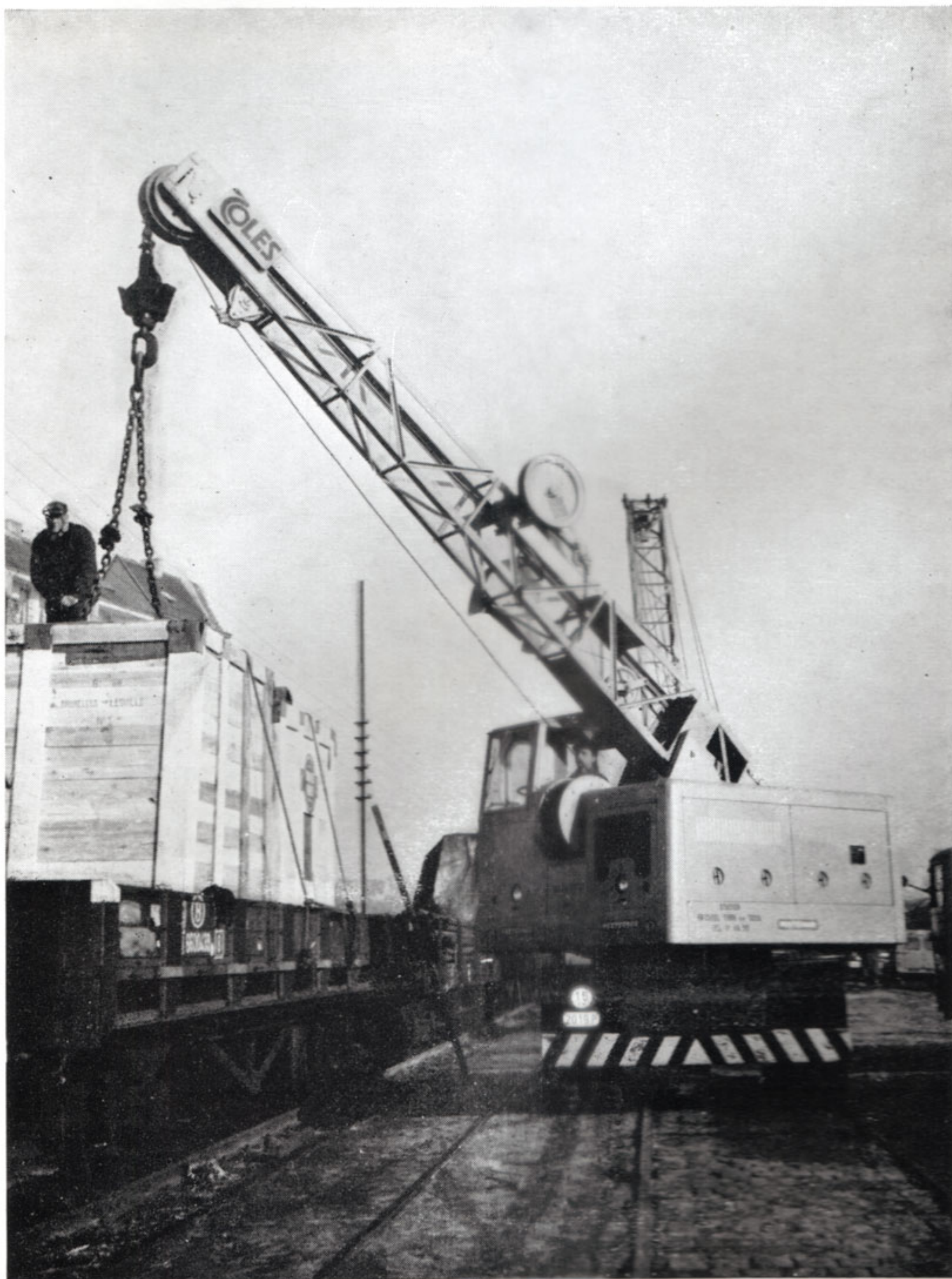
Grue automobile de 7 tonnes.
