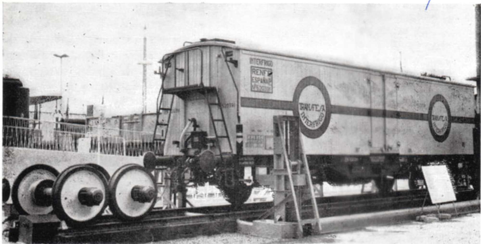
Wagon réfrigérant de la Société Transfesa, équipé de trains de roues interchangeables lui permettant de circuler sur les voies espagnoles (1,676 m) et normales (1,435 m).
