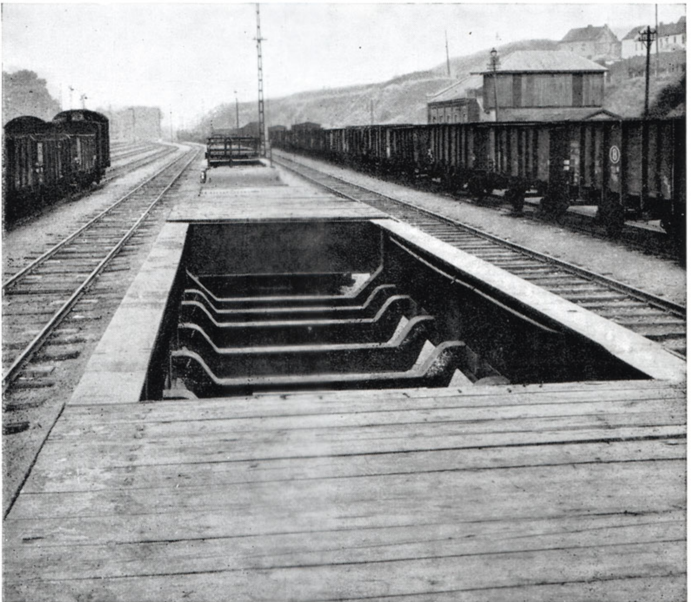
Partie centrale d'un wagon évidé de 53 t (série 1.099.500-1.099.509).
