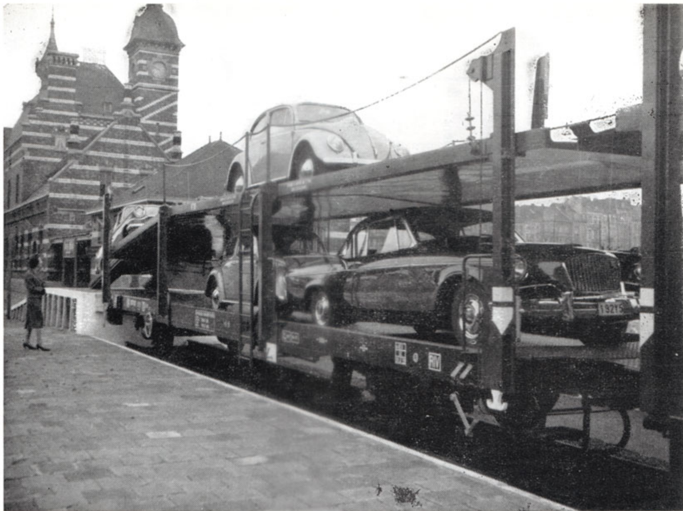
Vue d'un wagon à étage (série 1.076.000-1.076.059) en cours de chargement.
