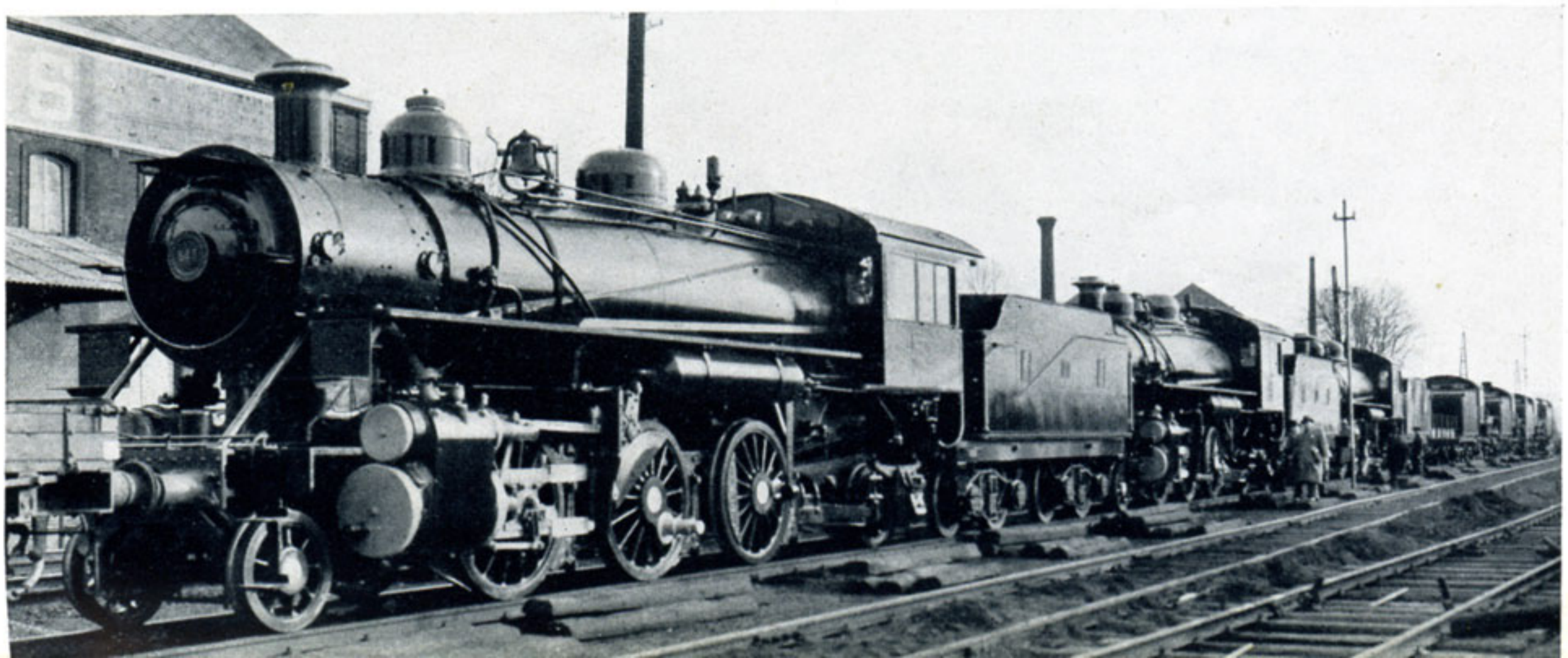
Fig. 17. — Série de locomotives type « Prairie » fournies à la Compagnie Générale de Chemins de Fer et de Tramways en Chine photographiées à leur sortie d'usine au moment de l'expédition.
